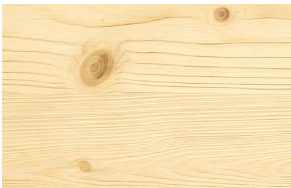
Surface brossée – brute, non traitée
