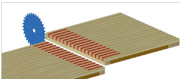
Řezání s ochrannými lamelami nebo jemnějším řezným kotoučem
