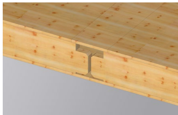
Opracování osazení – dvoustupňové.
