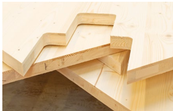
Dořezání tvaru stopkovou frézou (s rádiusem).
