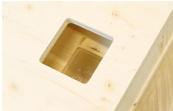
Frézování hranatých otvorů, provedení s rádiusem.
