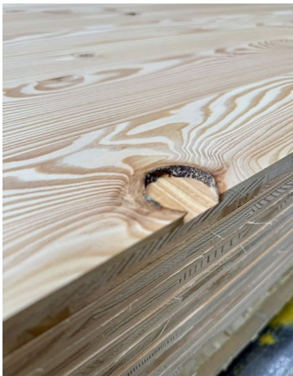
Trhliny nad 40 mm a vypadlé suky
