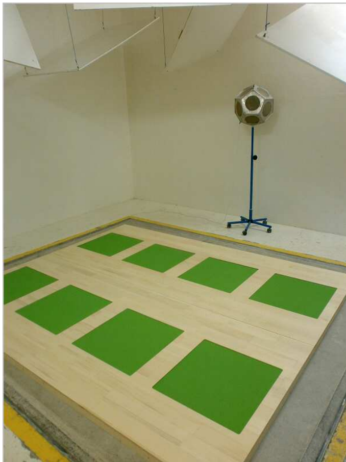
Zkušební vzorek v dozvukové místnosti
