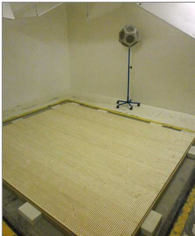
Zkušební vzorek v dozvukové místnosti
